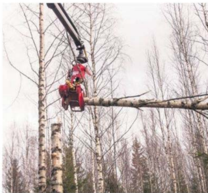
Energiapuukourassa pieneen tilaan pitäisi laittaa paljon tekniikkaa ohjaamaan peräkkäisiä liikesarjoja sylintereillä, mutta painoa ei saisi tulla ja kaiken pitäisi toimia mielellään ilman sähköjä ja oikeassa järjestyksessä.
