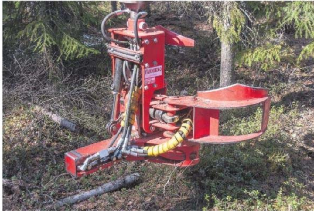
Energiapuukourassa pieneen tilaan pitäisi laittaa paljon tekniikkaa ohjaamaan peräkkäisiä liikesarjoja sylintereillä, mutta painoa ei saisi tulla ja kaiken pitäisi toimia mielellään ilman sähköjä ja oikeassa järjestyksessä.
