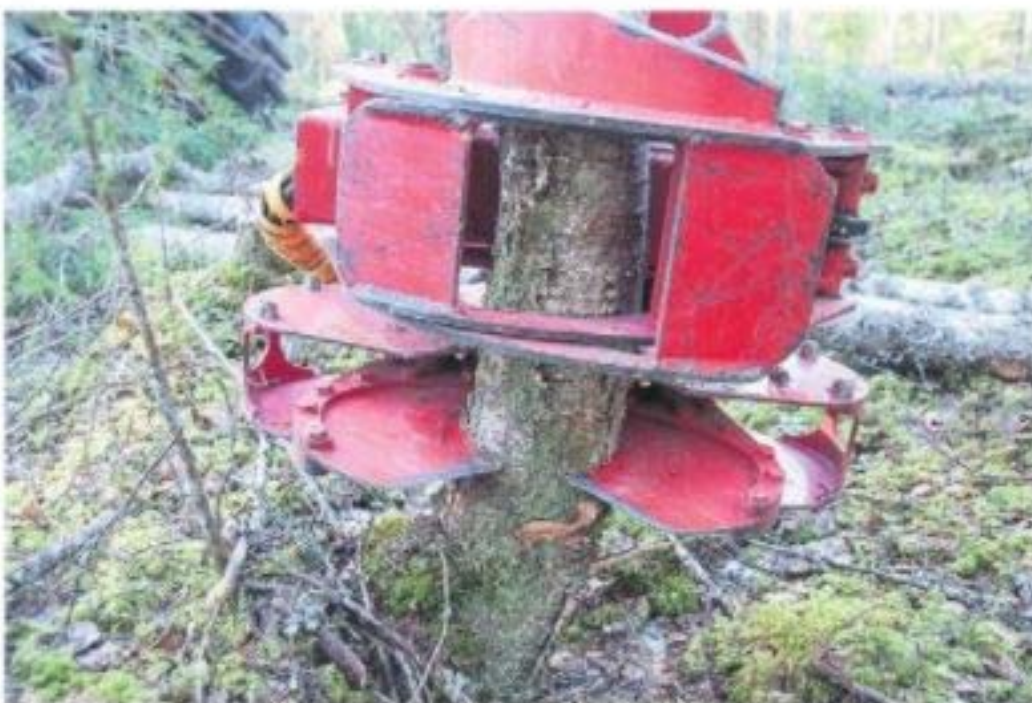
Koura kannattaa laskea runkoa pitkin ja nostaa hieman, kun koura ottaa maahan kiinni. Tällöin ei jää kiviä ja mossa terälle.
