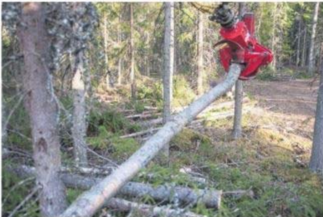
Kun liikkeen pysäyttää tilityn ollessa hieman kallellaan, peratut puut saa kuljetettua nätisti pystyssä ja puu kaadetaan lopullisesti vasta kasalla.
