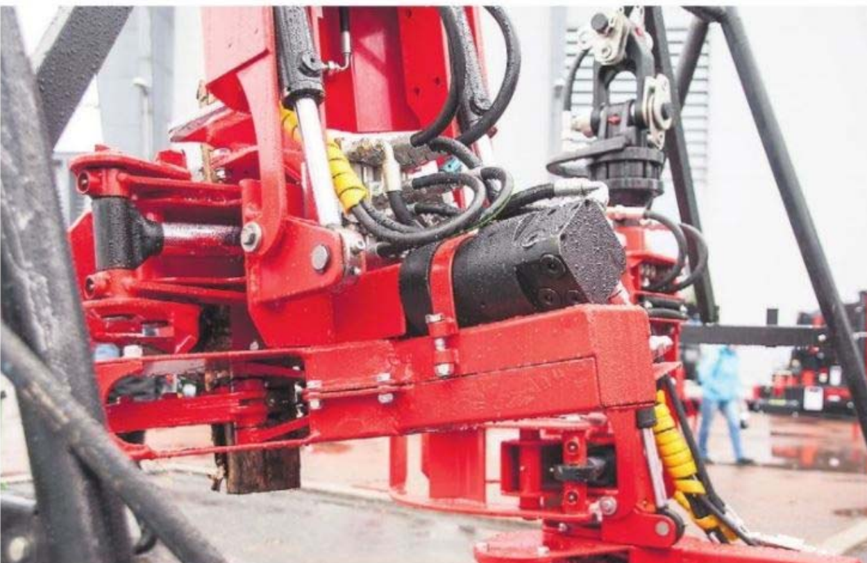
Farmikko esitteli KoneAgiassa aikaisempaa suuremman mallin, joka tottelee nimeä HT2. Uuden mallin letkutusta on myös uusittu, tilitrunkoon on tullut laippakiinnitys, johon sopii helposti adapterit eri kääntäjille. Kouriin on tehty myös tuotantoteknisiä parannuksia, jotka vaikuttavat hieman myös ulkonäköön.
