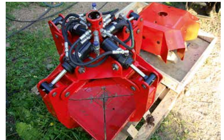
↑ Hydrauliiikan liitännät on toteutettu hyvin asiallisesti ilman iskuista löystyviä T-liittämiä. Kanavat on koneistettu kiinnikekappaleen raken- teeseen. Pienemmässä X10-mallissa kaikki liitännät jäävät lisäksi suoja- pellin alle suojaan.
