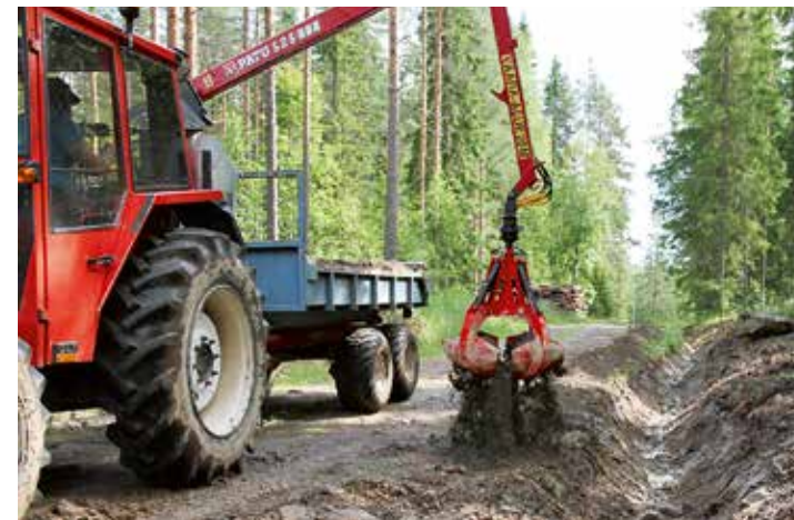
↑ Hienomman maa-aineksen annostelu onnistuu kohtuullisesti truk- kilavan kokoiselle alueelle, leuat aukeavat alkuun enemmän kärji- tään. Kostean hiekan käsittelyssä X10 tilavuudeksi mitattiin 88 litraa, X20 kooksi 141 litraa. Hiekka puristuu täyttövaiheessa kahmarin poh- jaa vasten, samalla tiivistyen.
