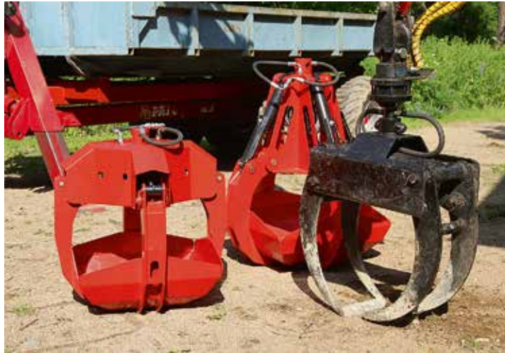
↑ ↓ Pienempi X10 vastaa korkeudeltaan pientä puutavarakouraa, sen sijaan X20 on selkeästi korkeampi. Se on syytä huomioida hankintavaiheessa, jotta perävaunun aisalle asennetun nosturin nosto- korkeus riittää korkealaitaisen vaunun kuormaamiseen.
